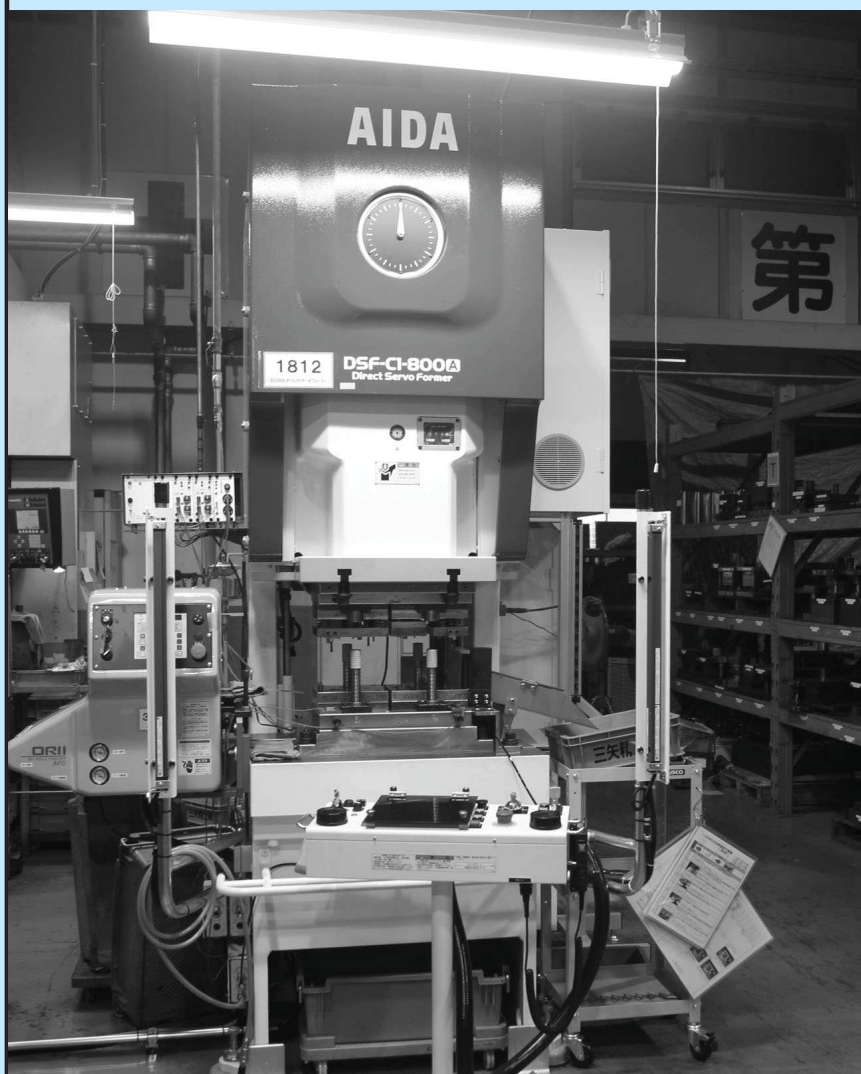
▲ 80トンサーボプレス機 ダイレクトサーボフォーマ「DSF-C1-800A」
