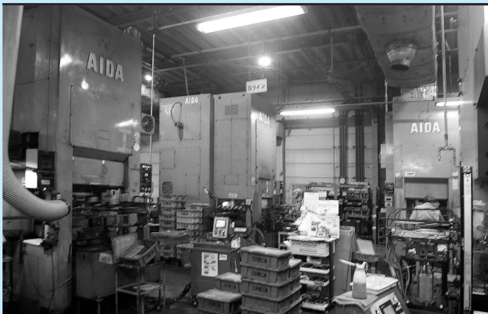
▲ K1-400トン3台による溝打ち、曲げ、丸めなどの加工ライン
